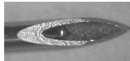
La punta dell’elettrodo correttamente posizionato deve essere visibile nella sezione smerigliata della cannula.
